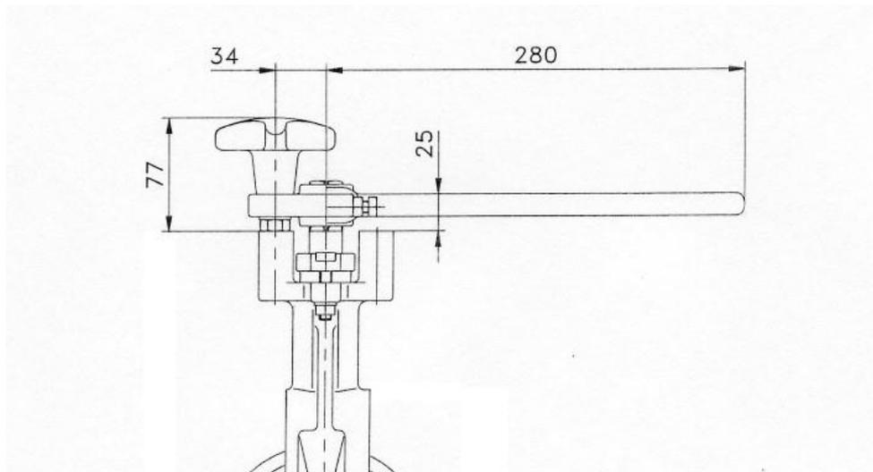
редуктор алюминиевый для Типа 07-002-В: для затвора дискового поворотного до DN 300
